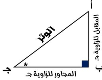
$$\text{جا ج} = \frac{\text{المقابل}}{\text{الوتر}} = \frac{\text{أ ب}}{\text{أ ج}} \quad (\text{جيب الزاوية } \sin)$$
